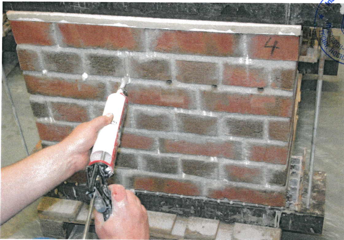
Bild B3: Injizieren mittels handbetriebener Kartuschenpumpe in die Prüfkörper
